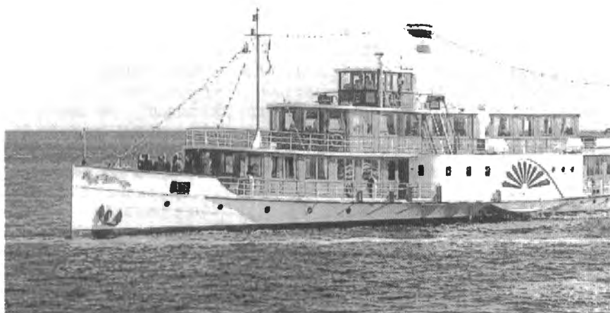
Der 51 Meter lange Seitenraddampfer „Freya“ wird | 1905 in Holland gebaute Schiff verfügt über zwei Se- | Zur Travemünder Woche wird der historische Damp- von einer 140 PS starken Maschine angetrieben. Das | lions. An Bord finden maximal 250 Passagiere Platz. | fer im Ostseebad festmachen. Foto: SAIL
